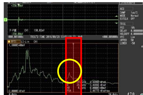
図 4-8 IE 波形データ (C2U (上)) 結果→△
