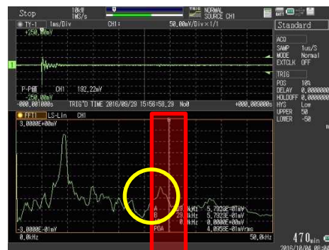
図 4-9 IE 波形データ (C2L(下)) 結果→△
