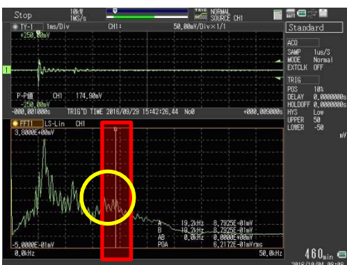
図 4-13 IE 波形データ (C5L (下)) 結果→△
