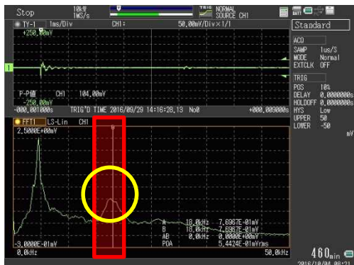
図 4-12 IE 波形データ (C4U (上)) 結果→△
