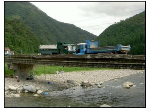
写真 2.3.7 二台載荷試験状況
