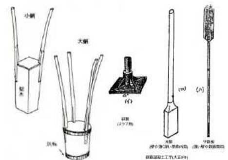
図-4 搦き固め器具(蛸・ランマー)
