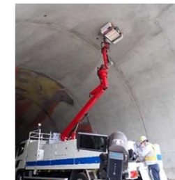
レーザー打音による変状の把握
