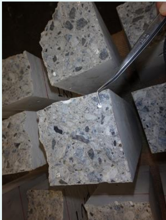
擬似ひび割れ間隙調整にアルミテープを貼付
