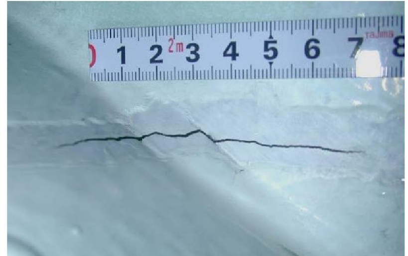
磁粉探傷試験後（塗膜厚除去後）
